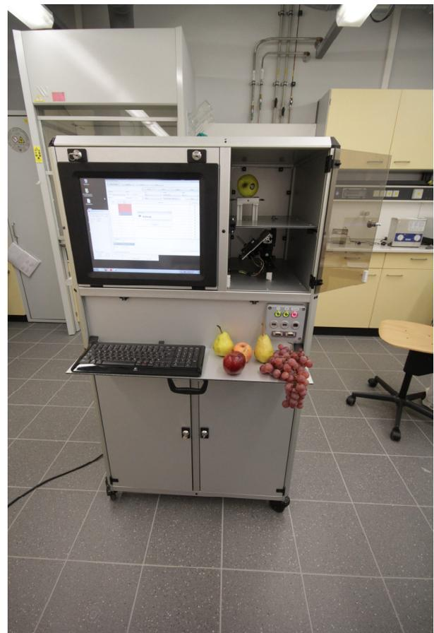
*Abb. 15: Gesamtansicht des Prototypen. Im Bild rechts ist in der geöffneten Messkammer oben die Desorptionszelle mit aufgelegtem Apfel und unten die Spiegelverstellung zu erkennen. Die Steuerung erfolgt wahlweise über das Touchscreen oder die Tastatur. Im geschlossenen unteren Bereich befinden sich Netzteile und Elektroverteiler.*
